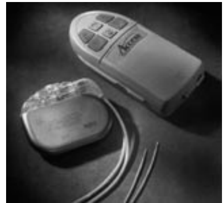
Abb. 2. Stimulationssystem mit Stimulationselektroden, Extensionskabel und Impulsgenerator. Der Impulsgenerator liefert die Energie für beide Stimulationselektroden. Rechts im Bild das für Patienten verfügbare Handprogrammiergerät.
